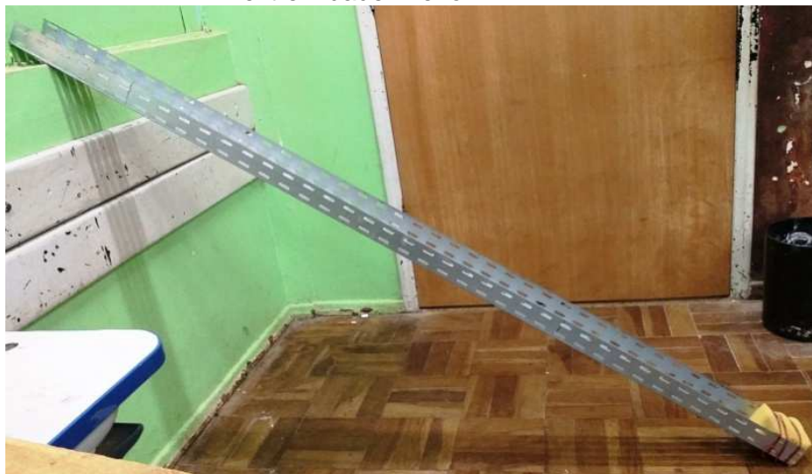
Figura 2.13 – Imagem da montagem do aparato experimental para o experimento do plano inclinado com o auxílio do Phyphox : canaleta de alumínio e espuma amarrada na extremidade inferior.
